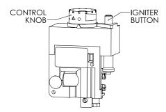
GAS CONTROL VALVE DIAGRAM
